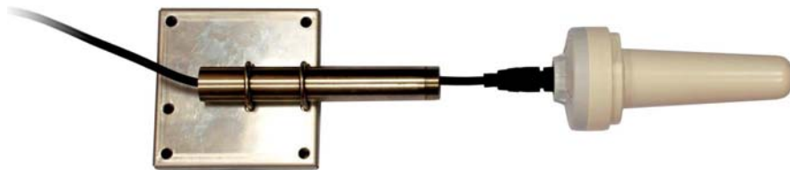
Рисунок Д.3 Подключение кабеля интерфейсного к антенне
